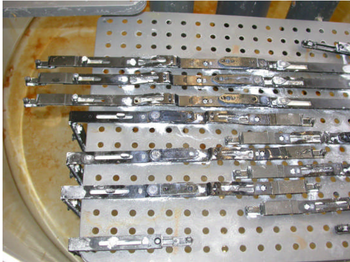
Bild 4: Bauteile nach 480 h
